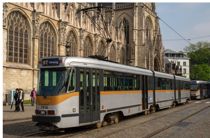
PCC 7916 (BN Constructions Ferroviaires et Métalliques, 1977) at the Petit Sablon stop, Rue de la Régence & Place du Petit Sablon.
